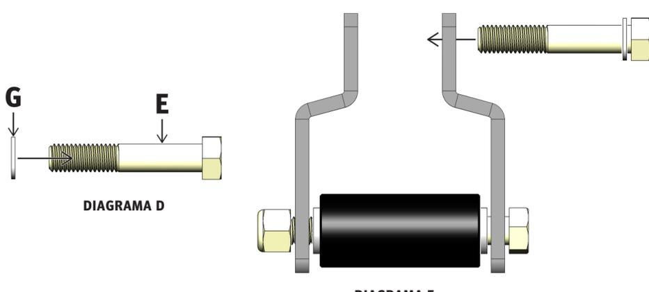
6. Complete la parte superior del conjunto del grillete colocando la segunda parte F Tuerca Nylock y la parte G Arandela plana de nylon en la parte E Perno hexagonal de 2 ¾" que se ha colocado a través de ambas patas del grillete (DIAGRAMA F).
