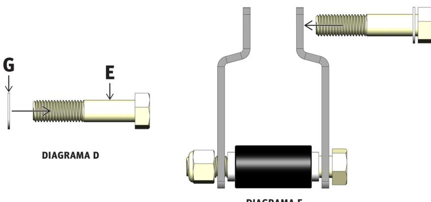
6. Complete la parte superior del conjunto del grillete colocando la segunda parte F Tuerca Nylock y la parte G Arandela plana de nylon en la parte E Perno hexagonal de 3 1/2" que se ha colocado a través de ambas patas del grillete (DIAGRAMA F).
