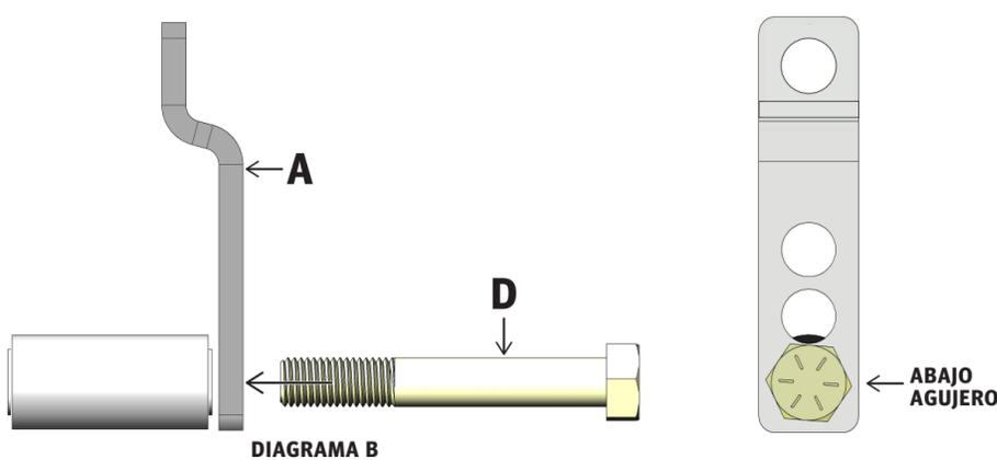
4. Con la mitad del grillete ensamblado, agregue la segunda parte A de la pata del grillete y la parte F de la tuerca Nylock al perno hexagonal de 5" (DIAGRAMA C) para completar la mitad inferior del grillete.
