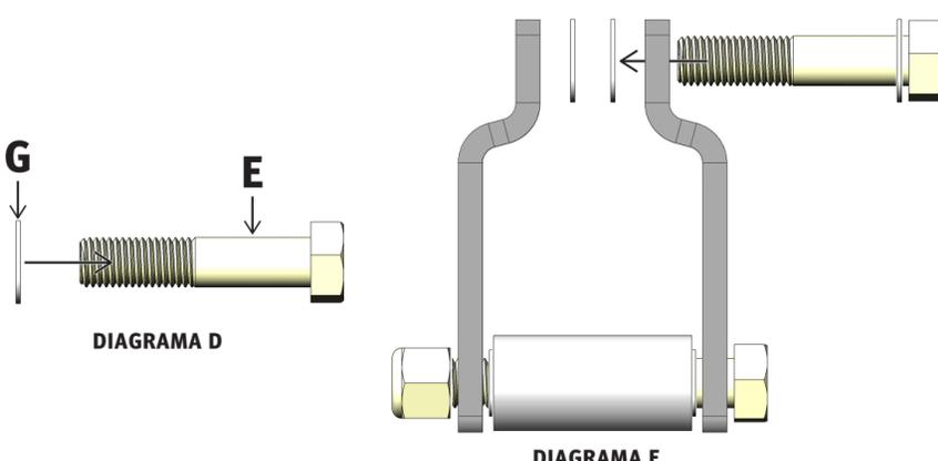
6. Complete la parte superior del conjunto del grillete colocando la segunda parte F Tuerca Nylock y la parte G Arandela plana de nylon en la parte E Perno hexagonal de 3 1/2" que se ha colocado a través de ambas patas del grillete (DIAGRAMA F).
