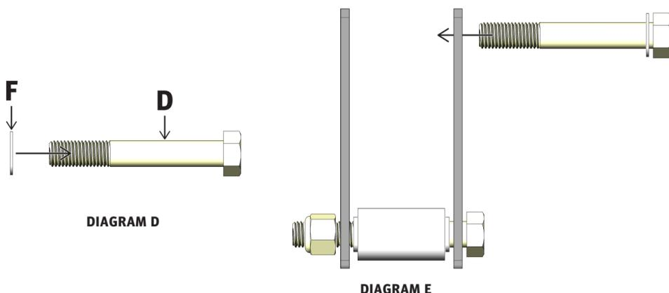
6. Complete la parte superior del conjunto del grillete colocando la segunda parte E Tuerca Nylock y la parte F Arandela plana de nylon en la parte D Perno hexagonal de 5" que se ha colocado a través de ambas patas del grillete (DIAGRAMA F).
