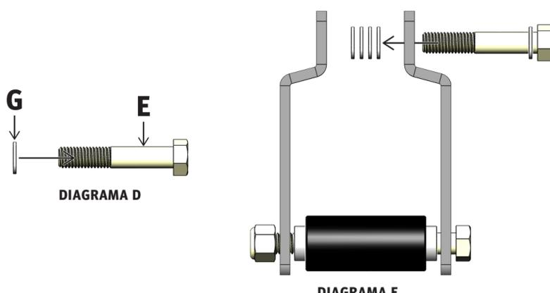
6. Complete la parte superior del conjunto del grillete colocando la segunda parte F Tuerca Nylock y la parte G Arandela plana de nylon en la parte E Perno hexagonal de 2 ¾" que se ha colocado a través de ambas patas del grillete (DIAGRAMA F).
