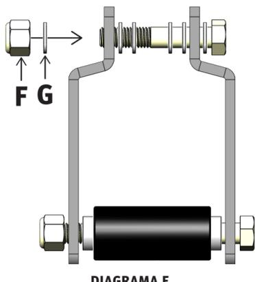
7. Termine el grillete completo colocando una calcomanía de No apretar la parte G en la parte superior de la pata del grillete al lado de la cabeza del perno de la parte D (DIAGRAMA G). El dedo en la etiqueta debe apuntar al perno de la parte E.
