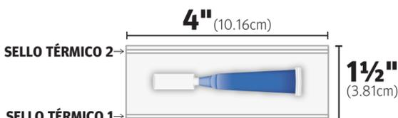
8. Inserte la abertura de la bolsa en el sellador térmico y repita el paso 6 para sellar la bolsa (SELLO TÉRMICO 2). Deje la bolsa a un lado.
